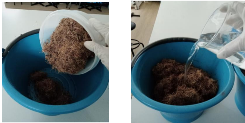
รูปที่ 9 เส้นใยถูกแช่ด้วยสารที่เตรียมไว้ เป็นเวลา 24 ชั่วโมง
