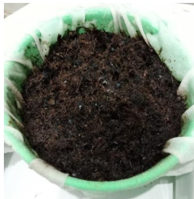
รูปที่ 10 นำเส้นใยมาล้างด้วยน้ำกลั่นจนมีค่า pH เป็นกลาง
