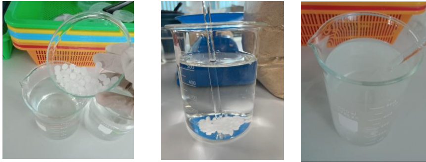
รูปที่ 8 การเตรียมสารละลายโซเดียมไฮดรอกไซด์
