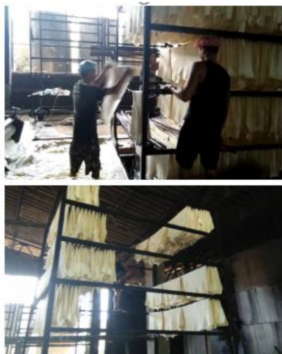
รูปที่ 4 ขั้นตอนการลำเลียงแผ่นยางขึ้นเก็บบนราวผึ่ง
