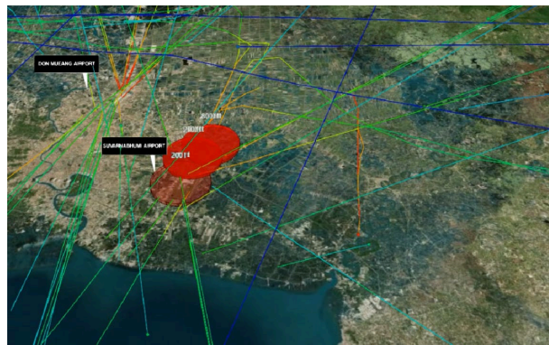
รูปที่ 3 ระบบอัตโนมัติตรวจจับระยะห่างและระดับความสูงระหว่างเครื่องบิน ที่มา: Yenpiem and Chaimatanun, 2017&2018
