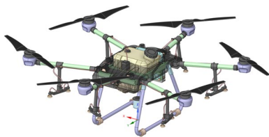
รูปที่ 4 แบบจำลองสามมิติของอากาศยานไร้คนขับทางการเกษตรลำต้นแบบ
