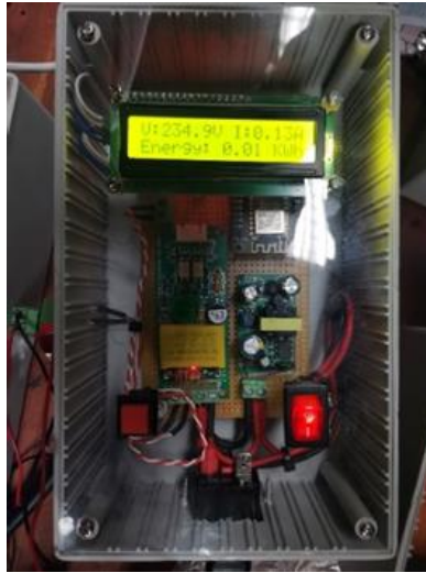
รูปที่ 6 มาตรวัดพลังงานไฟฟ้าดิจิทัลต้นแบบ
