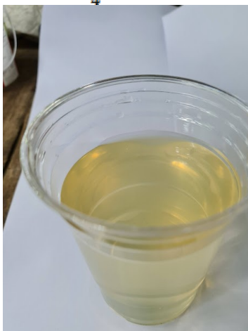
รูปที่ 7 ลักษณะน้ำบาดาลที่มีเหล็กละลาย ก่อนเข้าระบบกรอง
