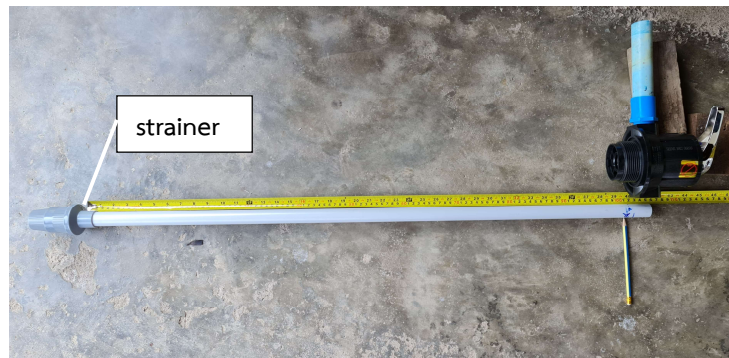
รูปที่ 5 ตัวกันสารกรอง (strainer) ที่ติดกับท่อภายในถังกรอง
