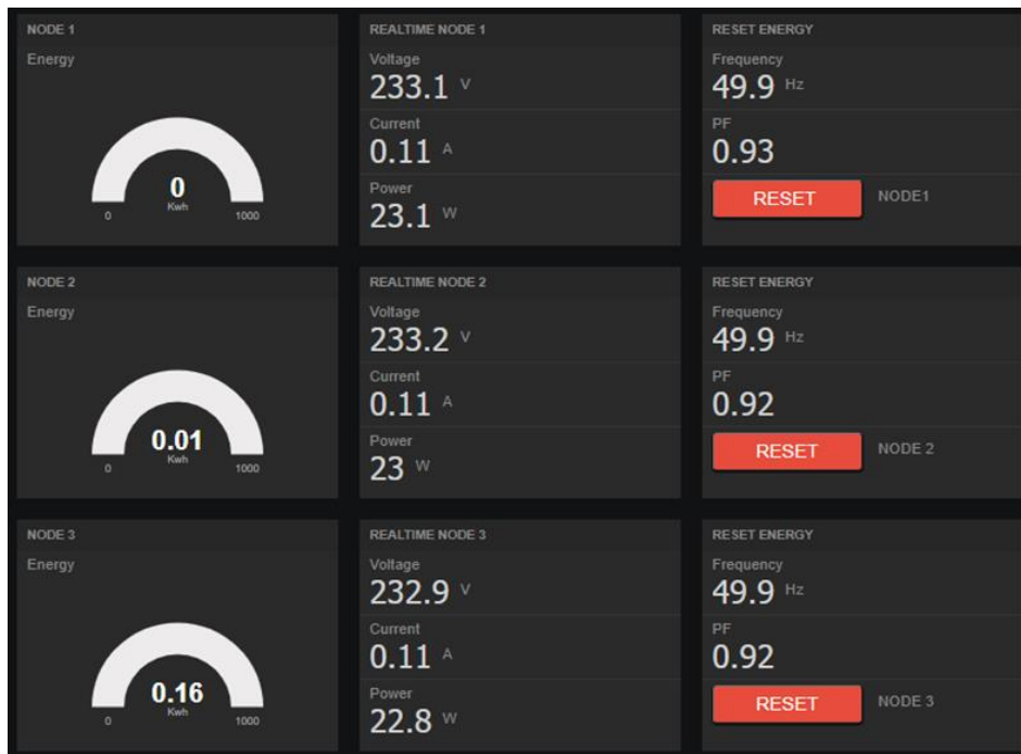
รูปที่ 7 ผลการทดลองวัดค่าทางไฟฟ้าด้วยมาตรวัดพลังงานไฟฟ้าดิจิทัลและนำไปแสดงผลบนแพลตฟอร์มเน็ตพาย
