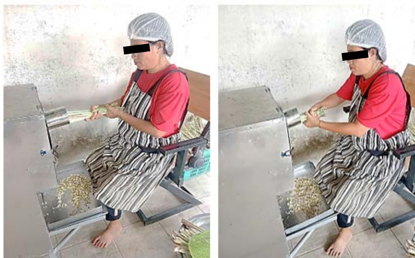
ภาพที่ 9 การหั่นตะไคร้ด้วยเครื่องหั่นและการนั่งทำงานของกลุ่มตัวอย่าง
