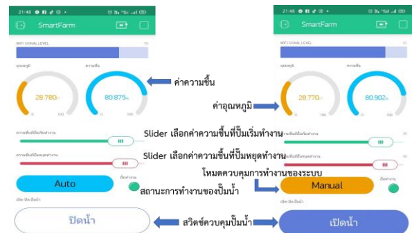
รูปที่ 3 การแสดงผลและควบคุมการพ่นหมอกผ่านแอปพลิเคชัน Blynk
