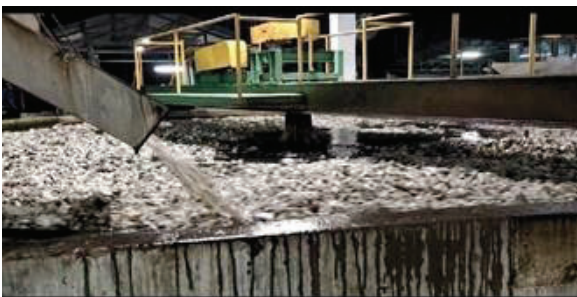
รูปที่ 3 ยางซีคูที่ตกหล่นระหว่างกระบวนการผลิต
