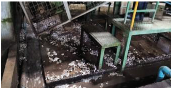
รูปที่ 2 ยางซีคูตกหล่นด้านล่างสายการผลิต
