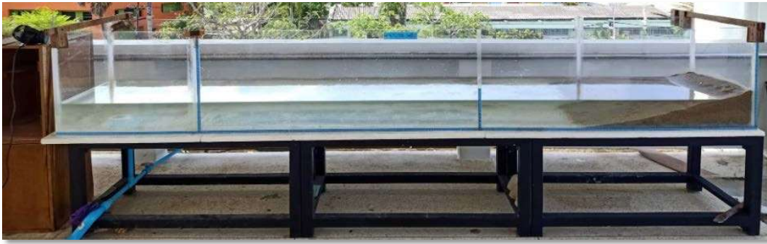
ภาพที่ 5 ตู้เก็บน้ำจากแผ่นอะคริลิกใส ขนาด 50X300X50 เซนติเมตร
