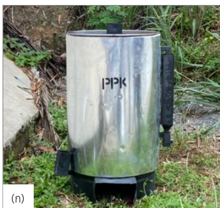
ภาพที่ 1 เครื่องมือที่ใช้ในการทำถ่านอัดแท่งเตาเผาถ่านไร้ควัน (ก) และเครื่องทำถ่านอัดแท่ง (ข)
