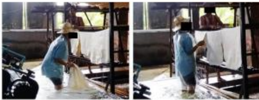
รูปที่ 6 ลำเลียงยางที่ผ่านเครื่องจักรรีด (ขั้นตอนที่ 10)
