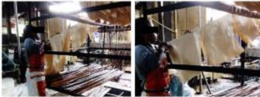
รูปที่ 11 ลำเลียงยางขึ้นล่าง (ขั้นตอนที่ 7)
