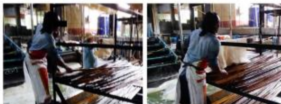
รูปที่ 9 ลำเลียงยางขึ้นล่าง (ขั้นตอนที่ 2)
