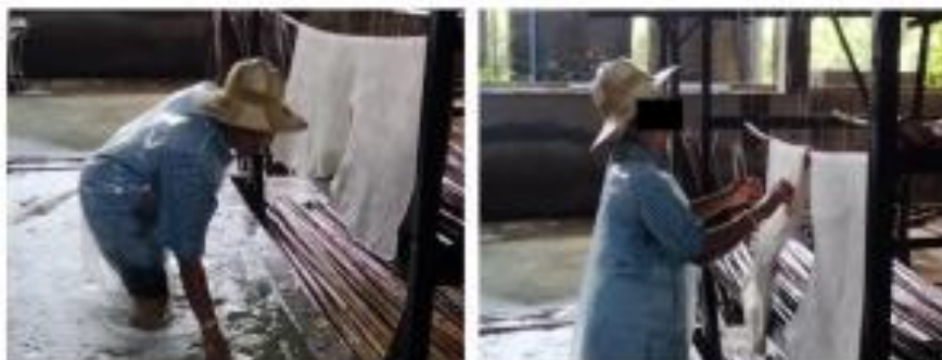
รูปที่ 5 ลำเลียงยางที่ผ่านเครื่องจักรรีด (ขั้นตอนที่ 9)
