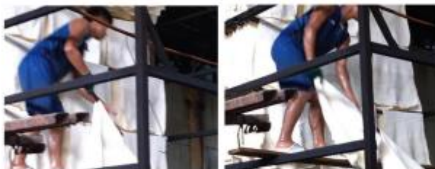
รูปที่ 18 ลำเลียงยางขึ้นบน (ขั้นตอนที่ 7)
