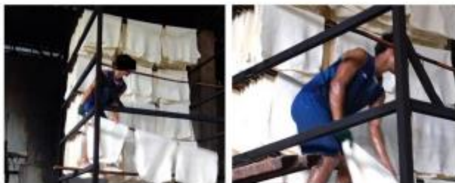
รูปที่ 20 ลำเลียงยางขึ้นบน (ขั้นตอนที่ 10)
