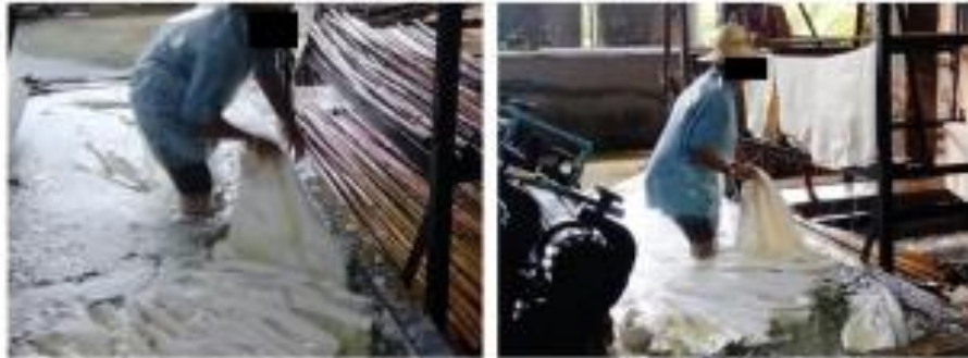
รูปที่ 4 ลำเลียงยางที่ผ่านเครื่องจักรรีด (ขั้นตอนที่ 7)
