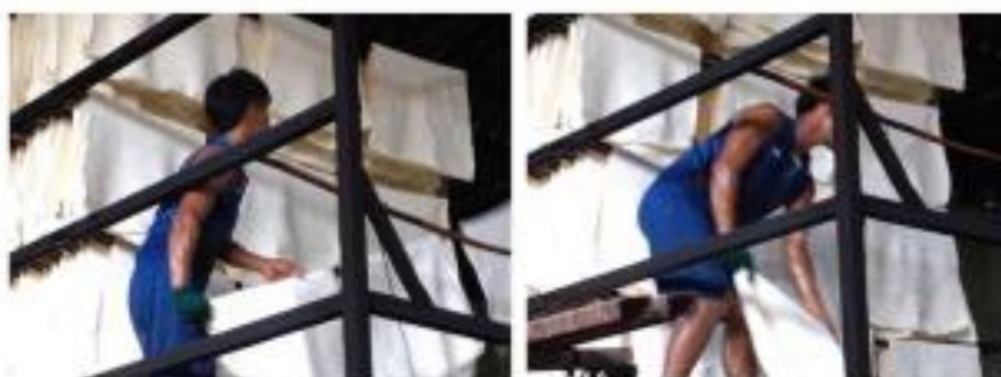
รูปที่ 16 ลำเลียงยางขึ้นบน (ขั้นตอนที่ 2)
