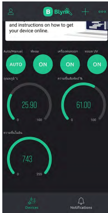
รูปที่ 5 หน้าต่างควบคุมผ่านทางแอปพลิเคชันพร้อมแสดงค่าในการควบคุมระบบ
