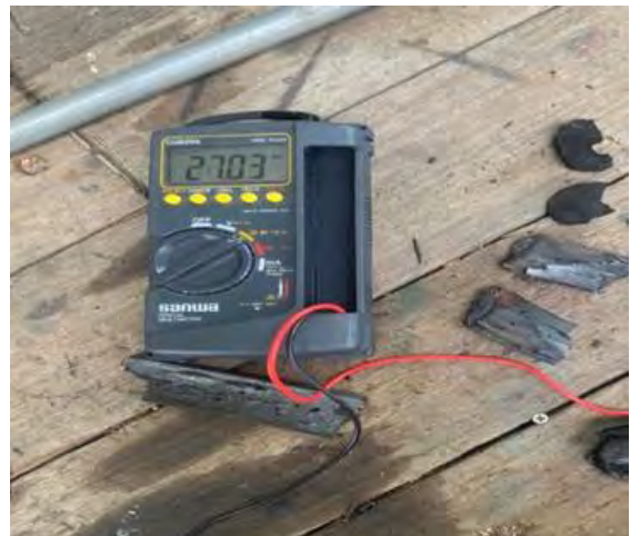
ภาพที่ 6 ไม้ยูคาลิปตัสที่ได้จากการอบในการทดลองครั้งที่ 4 และการทดสอบหาคาร์บอนในเนื้อไม้ยูคาลิปตัส
