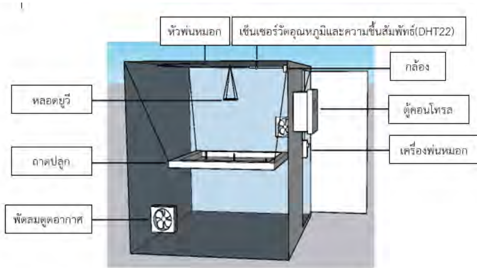
รูปที่ 3 การจัดวางอุปกรณ์ภายในโรงเรือนควบคุมการเจริญเติบโตต้นกล้วยไม้
