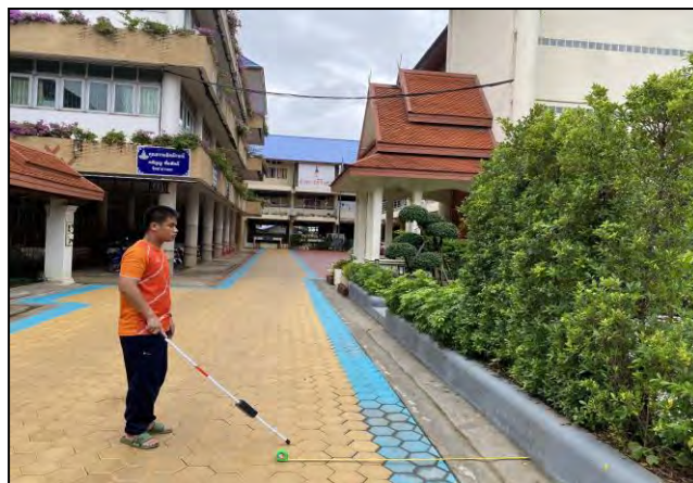
ภาพที่ 4 ผู้พิการทางสายตาที่ทำการทดลองไม้เท้าอิเล็กทรอนิกส์ได้หยุดเดินเมื่อได้ยินเสียงแจ้งเตือน ซึ่งด้านหน้ามีสิ่งกีดขวางหรือทางตันที่ไม่สามารถเดินต่อไปได้
