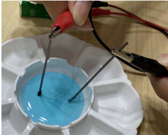
ภาพที่ 7 ผลการทดลองการแยกสลายสารละลายคอปเปอร์(II)ซัลเฟตด้วยกระแสไฟฟ้า
