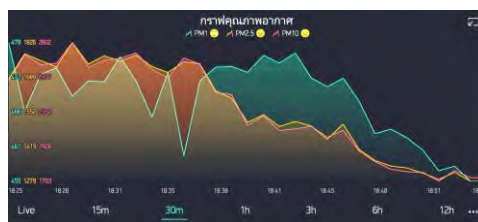
รูปที่ 18 ค่าคุณภาพอากาศแสดงผลด้วยแอปพลิเคชัน Blynk
