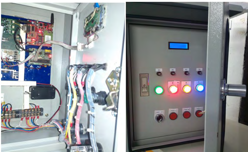
ภาพที่ 5 เครื่องตรวจสอบกระแสไฟฟ้าขัดข้องผ่านสมาร์ทโฟน
