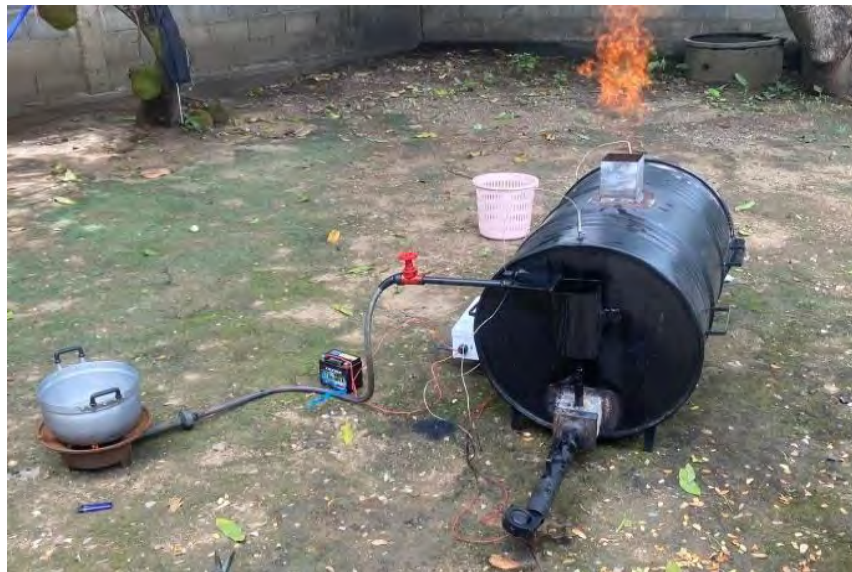
ภาพที่ 9 ทดลองการอบไม้ให้เป็นถ่านและนำแก๊สที่ได้จากไม้มาใช้แทนแก๊สหุงต้ม
