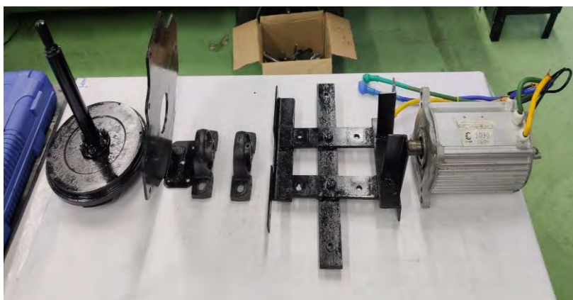
รูปที่ 5 แสดงชุดติดตั้งมอเตอร์ไฟฟ้า
