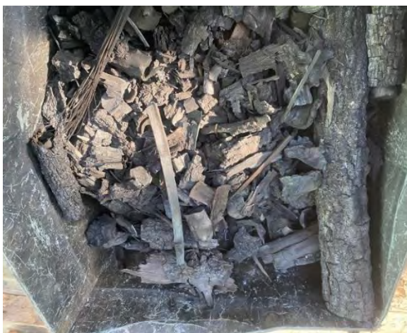
ภาพที่ 3 ไม้มะขามที่ได้จากการอบในการทดลองครั้งที่ 1 และการทดสอบหาคาร์บอนในเนื้อไม้มะขาม
