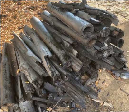
ภาพที่ 4 ไม้ไผ่ที่ได้จากการอบในการทดลองครั้งที่ 2 และการทดสอบหาคาร์บอนในเนื้อไม้ไผ่
