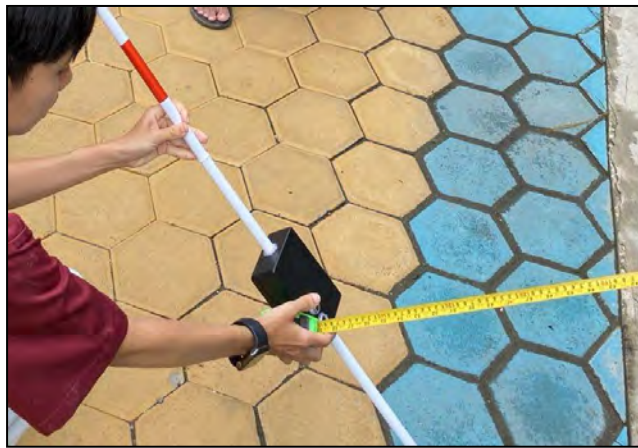
ภาพที่ 5 ไม้เท้าอิเล็กทรอนิกส์สามารถแจ้งเตือนด้วยเสียงได้เป็นอย่างดีเมื่อพบสิ่งกีดขวางได้ในระยะที่กำหนด
