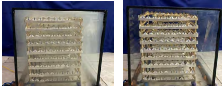
รูปที่ 14 แบบจำลองด้วยชุดอิเล็กทรอนิกส์แบบปลายแหลมกับปลายแหลมเพื่อแสดงการทดสอบกำจัดควัน
