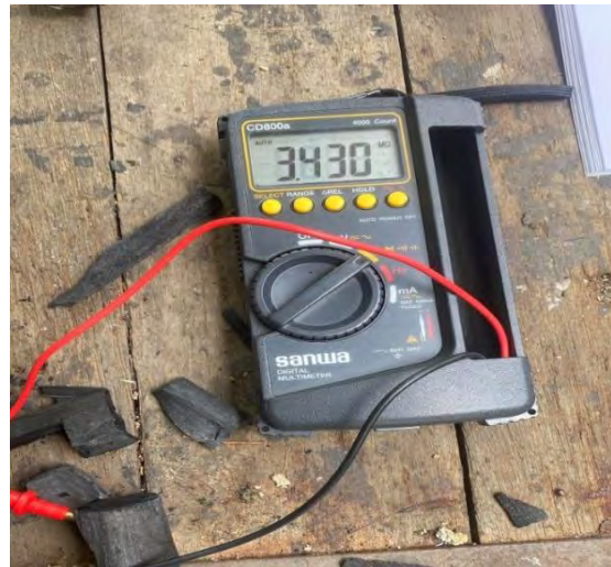
ภาพที่ 5 ไม้ยางพาราที่ได้จากการอบในการทดลองครั้งที่ 3 และการทดสอบหาคาร์บอนในเนื้อไม้ยางพารา
