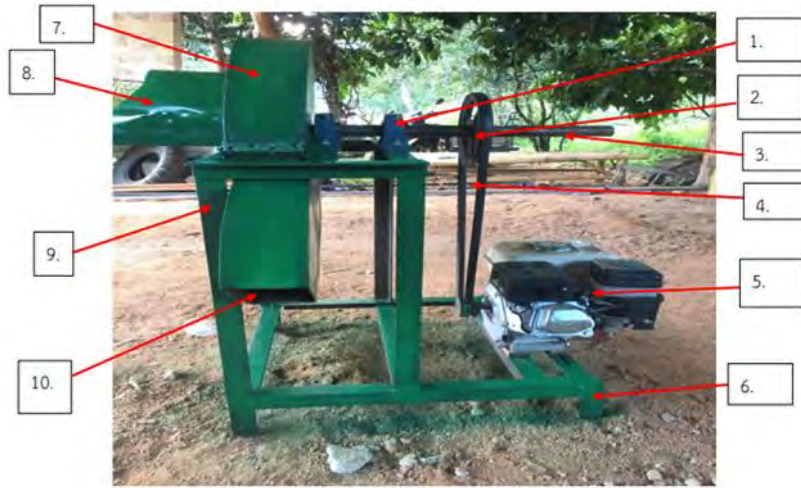
1.แปรง, 2.ฟูลีย์เพลลา, 3.เพลลาขับ, 4.สายพาน, 5.เครื่องยนต์ต้นกำลัง, 6.โครง, 7.ฝาครอบ, 8.ช่องป้อนวัชพืช, 9.ฐานรองชุดใบมีด, 10.ช่องทางออกวัชพืชที่สับแล้ว
