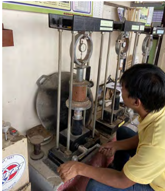
รูปที่ 7 การทดสอบหาค่ากำลังอัดของตัวอย่างดินซีเมนต์ในห้องปฏิบัติการทดสอบดิน
