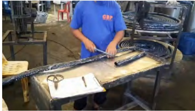
รูปที่ 7 โตะตัดยางแบบเก่า
