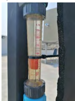
(ก-7) อุปกรณ์วัดอัตราการไหลของน้ำ
