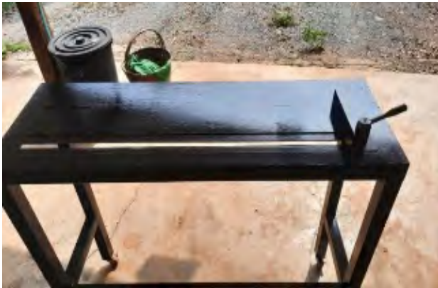
รูปที่ 8 โตะตัดยางที่ออกแบบใหม่
