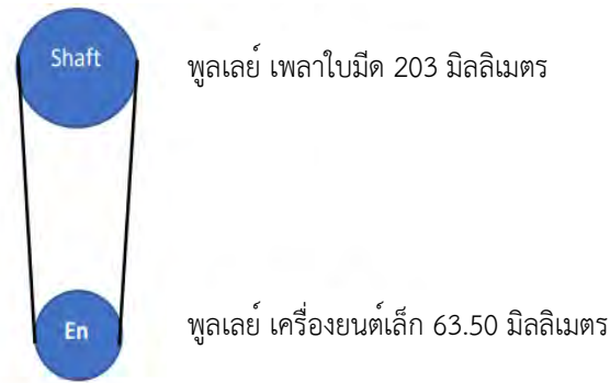
ภาพที่ 1 ความอัตราทดชุดส่งกำลังและขับ าล์
