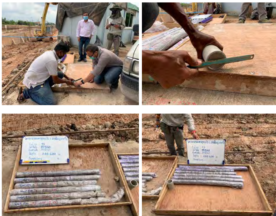
รูปที่ 6 การเก็บตัวอย่างดินซีเมนต์ในภาคสนามเพื่อนำมาทดสอบหาค่ากำลังในห้องปฏิบัติการทดสอบดิน
