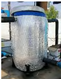
(ก-1) ถังน้ำร้อนขนาดเล็ก
