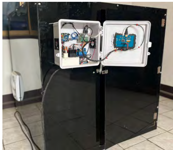
รูปที่ 12 ภาพภายในโรงเรือนจาก Raspberry Pi Camera Module และต้นแบบระบบควบคุมโรงเรือนอนุบาลกล้วยไม้ด้วยระบบอินเทอร์เน็ตทุกสรรพสิ่ง
