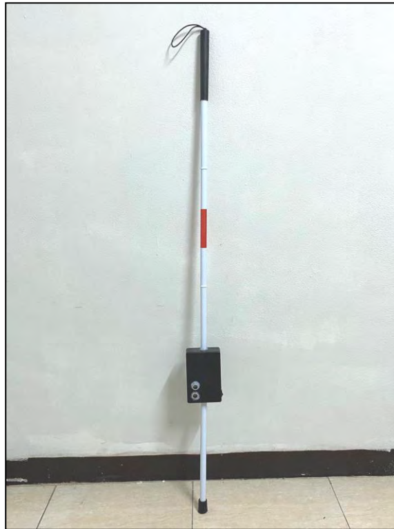
ภาพที่ 2 ไมค์ทำอัลตราซาวด์สำหรับผู้พิการทางสายตา
