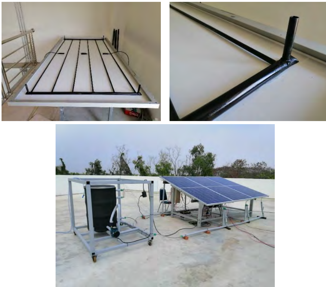
รูปที่ 5 ชุดระบายความร้อนใต้แผงเซลล์แสงอาทิตย์ และระบบทดสอบ (สร้างจริง)
