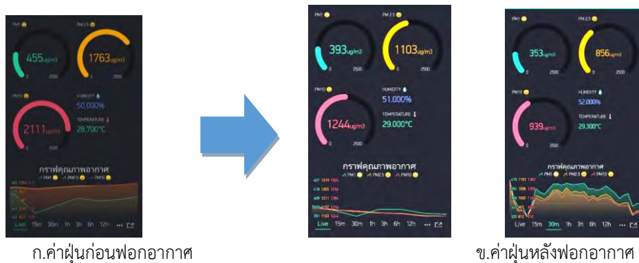
รูปที่ 15 ค่าฝุ่นพีเอ็ม1,พีเอ็ม2.5 และพีเอ็ม10 ก่อนฟอกอากาศและหลังฟอกอากาศ
