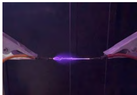
รูปที่ 13 การทดสอบการทำงานของวงจรสร้างไฟฟ้าแรงดันสูงด้วยชุดอิเล็กทรอนิกส์
