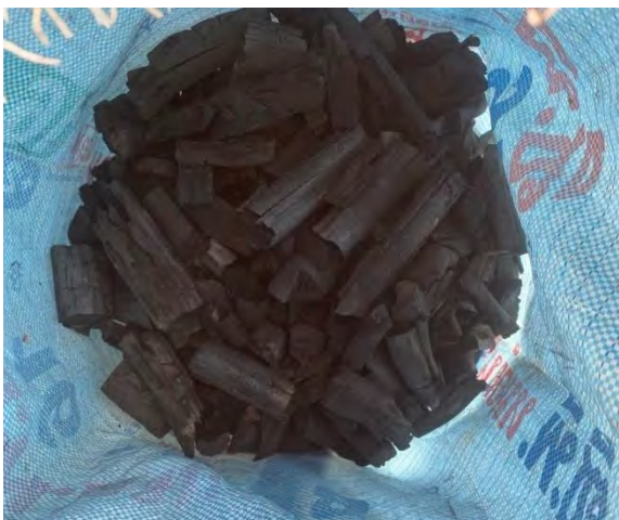
ภาพที่ 6 ไม้ยูคาลิปตัสที่ได้จากการอบในการทดลองครั้งที่ 4 และการทดสอบหาคาร์บอนในเนื้อไม้ยูคาลิปตัส
