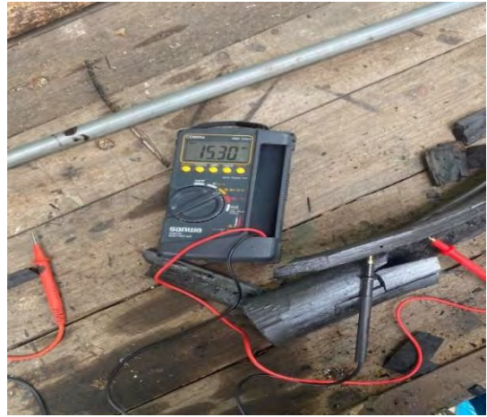
ภาพที่ 5 ไม้ยางพาราที่ได้จากการอบในการทดลองครั้งที่ 3 และการทดสอบหาคาร์บอนในเนื้อไม้ยางพารา
